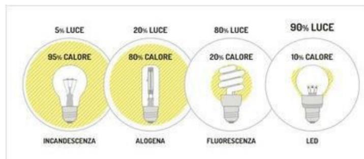
*Le lampade a LED (Diodi ad Emissione Luminosa) sono dispositivi luminosi costituiti da piccoli chip di silicio in grado di convertire la corrente elettrica direttamente in fonte luminosa. Inizialmente impiegati solo nell'elettronica, oggi sono impiegati in tutti i settori compreso quello domestico.*
